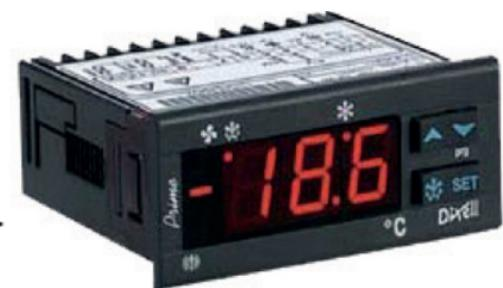
Anzeige von Alarm, Dauer und erreichter Max-/Min-Temperatur
